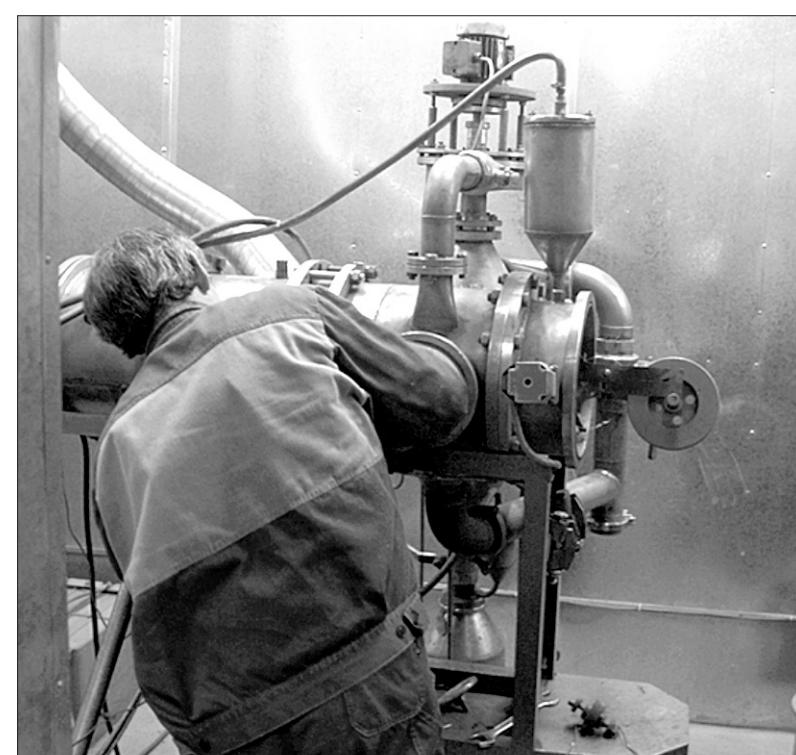
На специальной установке стержень металлического проводника разрывается разрядом электрического тока, мощность которого в миллионы раз превосходит удар молнии.
